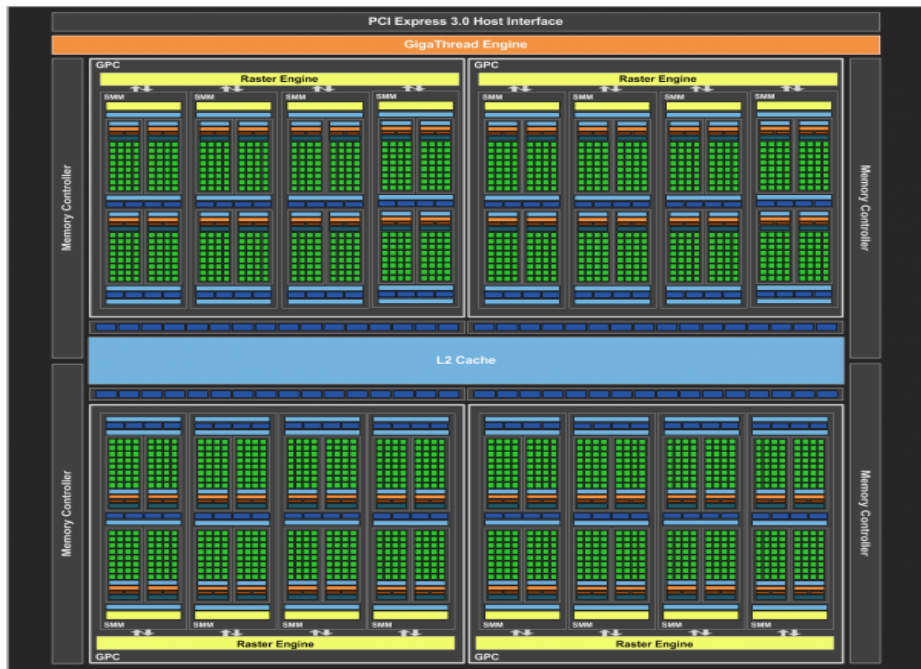
Figure 1: Organisation globale de l'architecture Maxwell (GeForce GTX980)
